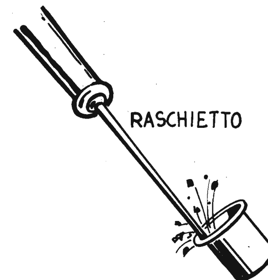
Fig. 10 - Una volta tolto il cappuccio dalla valvola, questo va perfettamente pulito nelle sue parti interne servendosi di adatto raschietto.
